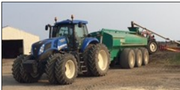
Tracteur New Holland, 300 forces, suspension entière, muni d'un GPS, utilisé pour l'épandage du fumier, l'ensilage, etc. acquisition en 2014.
